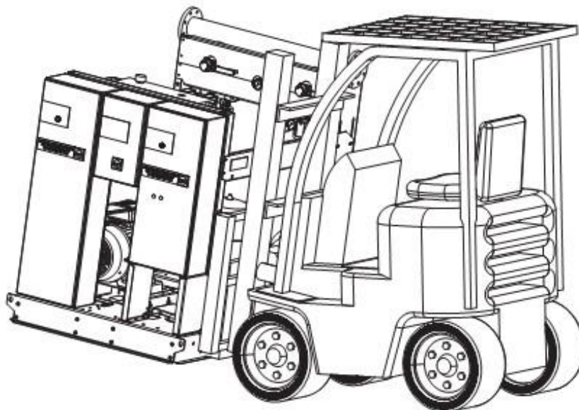
Рис. 1 Схема перемещения установки к месту монтажа
